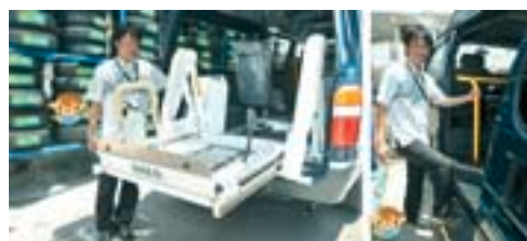
改造により手すりをつけたリフト付介護車両（レンタル用）
