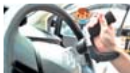
ハンドル及びアクセル・ブレーキを改造した自操式福祉車
